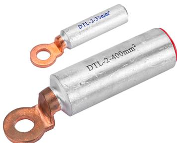
BIMETÁLICOS Aplicação para ligação de cabo-barramento (cabo Alumínio-Al e barramento de Cobre-CU); Estrutura que oferece: Maior condutividade entre cabo e terminal; Melhor conexão entre terminal e barramento; Elimina a possibilidade de oxidação galvânica entre os contatos;
