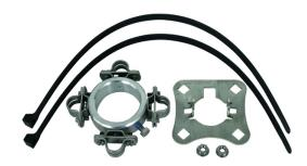
SUPORTE PARA CONDUTOR HVI Kit de fixação para instalação do condutor longo HVI em tubos de suporte HVI, Composto por uma placa de conexão para quatro condutores Incluso duas porcas de segurança e um anel de fixação com quatro suportes de condutor ranhurado (Ø20 mm) para a extremidade de vedação Incluso duas abraçadeiras
