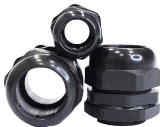
Conectadas nos conduítes flexíveis para aprimorar o acabamento da instalação. Para o acoplamento é necessário soltar a peça de prensagem, encaixar o conduíte na ranhura da terminação e fazer o aperto da peça com a ferramenta apropriada. Esse tipo de terminação é indicado para os casos de montagens sob movimentos ou vibrações constantes.
