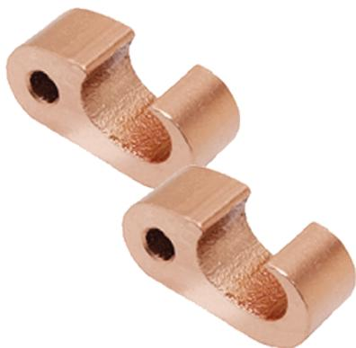
CABO-HASTE Atende a um range de: Cabos 16 a 120mm<sup>2</sup>; Haste de 1/2" – 3/4"; Feito de cobre eletrolítico puro; Fabricado por processo de extrusão, garantindo 99,9% de pureza; Benefícios: Rapidez; Qualidade; Integridade do sistema; Maior condutividade;
