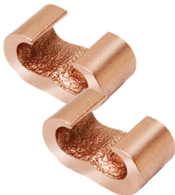
CABO-CABO Atende a um range de cabos de 16 a 120mm<sup>2</sup>; Feito de cobre eletrolítico puro; Fabricado por processo de extrusão, garantindo 99,9% de pureza; Benefícios: Rapidez; Qualidade; Integridade do sistema; Maior condutividade;
