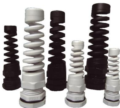
Série PCB-ESP Prensa cabo espiral com aliviador de tensão desenvolvido especialmente para prevenir dobras, ressecamento e rompimento dos cabos em aplicações com risco de influencias externas, determinando o raio de curvatura. Fabricado em Poliamida; Rosca Gás (BSP); Grau de Proteção IP68; Aplicações: Caixas de Passagem; Painéis e Caixas de Comando; Fabricantes de Máquinas e Equipamentos
