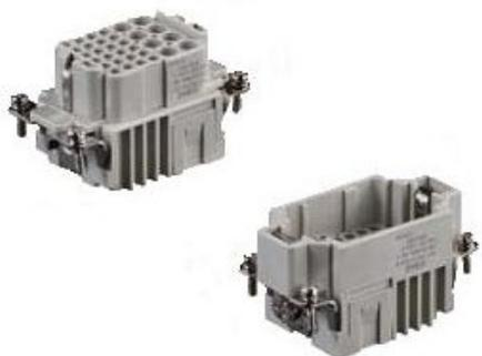
Os insertos da Série HK integram numa única peça conexões elétricas de controle e potência, com contatos de valores diferentes. Os insertos podem incorporar os contatos com terminação axial, contato por parafuso ou contatos de crimpar, sendo os últimos fornecidos separadamente. Os insertos são produzidos em poliamida com resina plástica auto-extinguível UL94 V0, material isolante que suporta altas temperaturas e possui excelentes propriedades elétricas, mecânicas e químicas.
